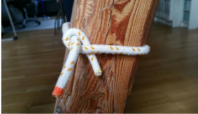
Umwicklung der festen Part mit der losen Part
